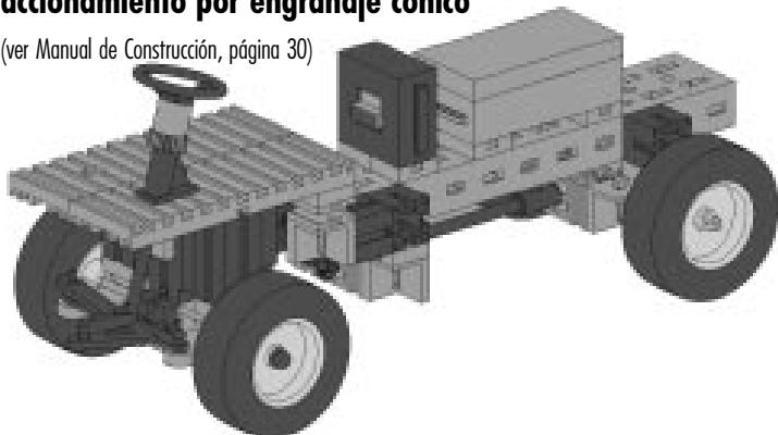
Este modelo lleva un accionamiento típico de camión de carga. Alante, debajo de la cabina – no existente en nuestro modelo – se halla el motor. La fuerza es transmitida a la rueda trasera por medio de un árbol de accionamiento. Para la transmisión de la fuerza en ángulo recto utilizamos los llamados engranajes cónicos, llamados así porque su dentado va inclinado en dorma coniforme.
