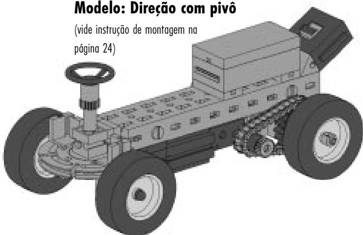
No caso da chamada direção com pivô todo o eixo dianteiro é montado sobre uma prancha ou uma placa redonda e esta fixada ao veículo de modo pivotante. O eixo dianteiro completo gira em torno do centro de pivotagem e o veículo pode ser dirigido. Dado que numa curva ambas as rodas descrevem percursos diferentes, elas precisam estar apoiadas no eixo com rotação móvel, para que possam girar a velocidades diferentes.
