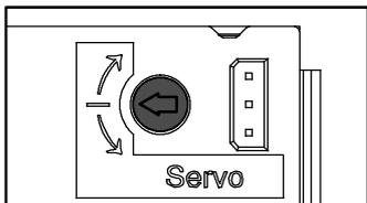
2. Trimmer in Mittelstellung drehen / Turn the trimmer to the middle setting / Tourner le régulateur sur la position du milieu / Trimmer in de middelste stand draaien / Girar el trimer a la posición central / Girar o condensador de compensação para a posição central / Portare il trimmer in posizione centrale / Установите подстроечный конденсатор в среднее положение / 将微调器旋转到中间位置
