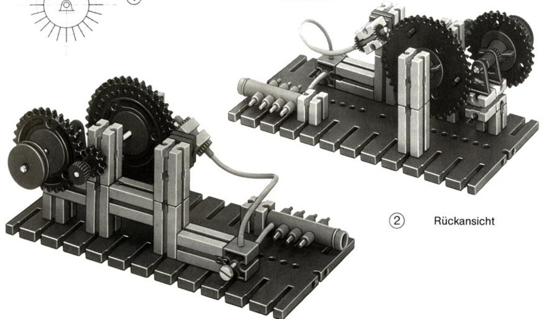
Die Turbinendrehzahl kann durch ein vorgeschaltetes Drosselventil (P-Drossel) gesteuert werden. Da aber dieses Ventil auch in völlig geöffnetem Zustand noch eine gewisse Drosselwirkung aufweist, erzielt man die maximale Drehzahl nur ohne dieses Ventil.
