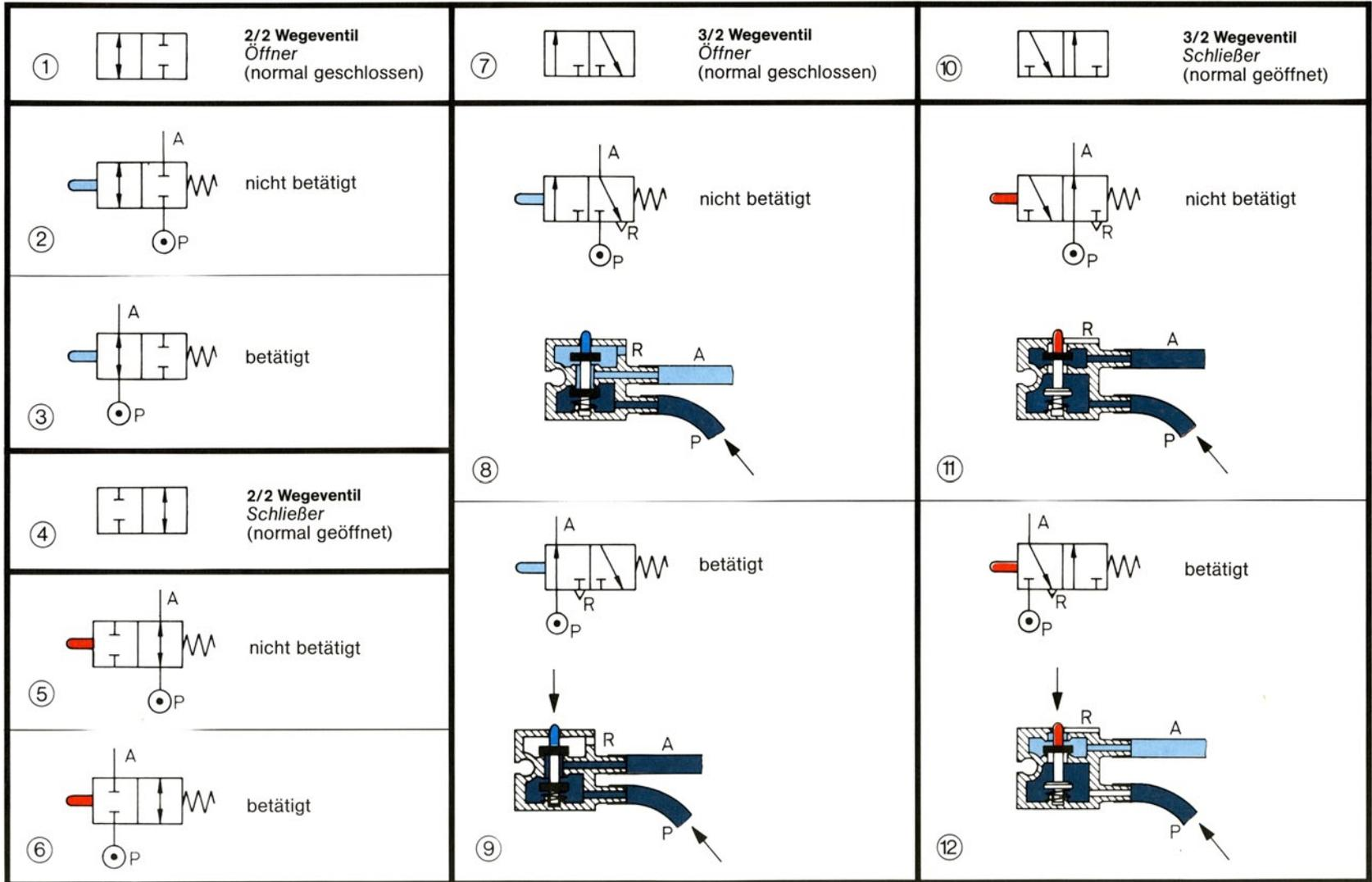
Arbeitsleitung und R für die Entlüftung. Unser Pneumatikkasten enthält drei 3/2-Wegeventile als Öffner und ein 3/2-Wegeventil als Schließer. Die Öffner sind am blauen, der Schließer ist am roten Stößel zu erkennen.
