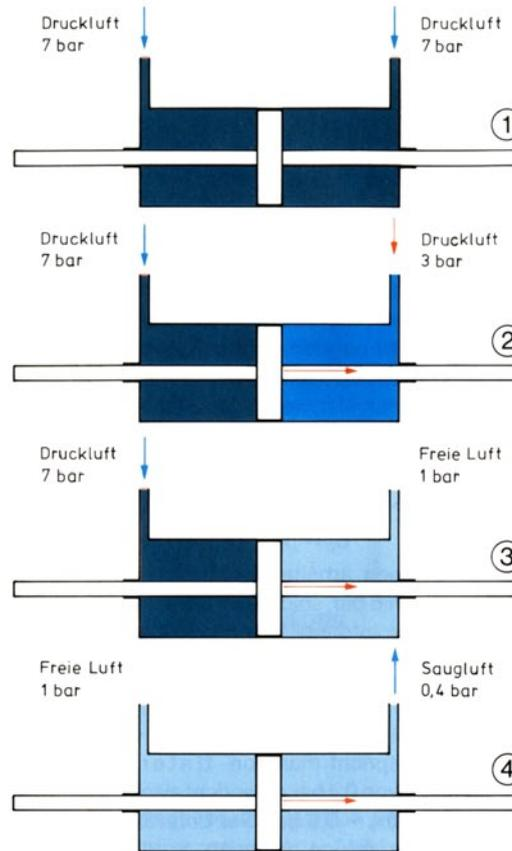
Verbindet man nach Bild 3-7 die rechte Zylinderseite mit der Umgebungsluft, der sogen. *freien Luft*, deren Druck etwa 1 bar beträgt, so steigen Kraft und Geschwindigkeit der Kolbenbewegung gegenüber Bild 2-7 an.
