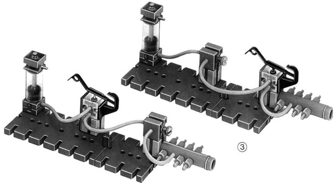
Abluft gedrosselt, so daß Hin- und Rückgang mit verminderter Geschwindigkeit erfolgen. Bild 3-54 zeigt die zugehörigen Modelle, welche die unterschiedliche Wirkung des Einbauortes der P-Drossel erkennen lassen. Beim Modell der Hebebühne (Bild 3-40) hatten wir bereits eine Schaltung nach Bild 2-54 vorgesehen.
