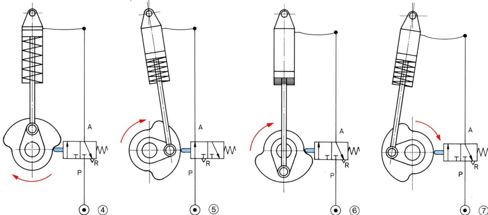
Dies ist die einfachste Bauart eines Druckluftmotors, die mit unserem Baukasten herstellbar ist. Der bewegliche Zylinder macht auch den mechanischen Aufbau völlig problemlos. Die Schaltung ist nichts anderes als die Programmsteuerung eines einfachwirkenden Zylinders, wie wir sie von Bild 1-34 her kennen. Der Unterschied liegt nur darin, daß die Nockenscheibe direkt von der Kurbelwelle angetrieben wird. In Bild 4-7-58 ist die Arbeitsweise dargestellt. In der obersten Kolbenstellung, auch *oberer*
