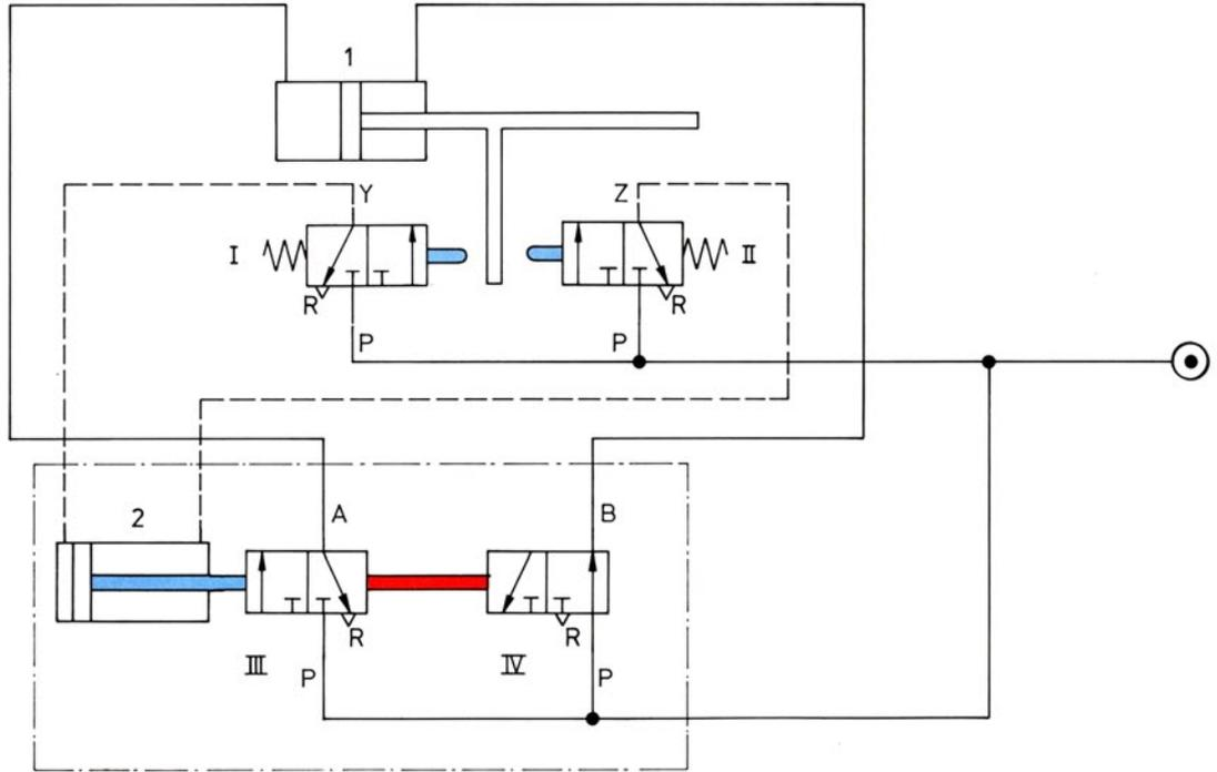
näheres auf Seite 54. Übrigens hat diese Schaltung eine eingebaute Sicherungsfunktion. Kann nämlich aus irgendeinem Grunde die Bewegung des Arbeits- oder des Steuerkolbens nicht zuende geführt werden, so bleibt die gesamte Anlage stehen. Damit ist sichergestellt, daß der Arbeitshub entweder in voller Länge oder gar nicht ausgeführt wird. Dies kann am Modell leicht erprobt werden.
