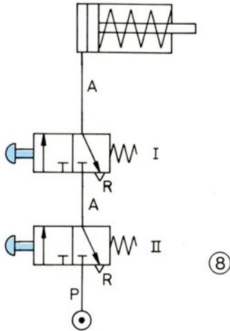
Es sei die Forderung gestellt, daß der Zylinder nur dann Druckluft erhalten soll, wenn beide Ventile I und Ventil II betätigt sind. Schreibt man für »betätigt« das Zeichen »1« und für »nicht betätigt« das Zeichen »0«, entsprechend beim Zylinder »1« für »Zylinder an Druckluft« und »0« für »Zylinder an Entlüftung«, so ergibt sich folgender Zusammenhang:
