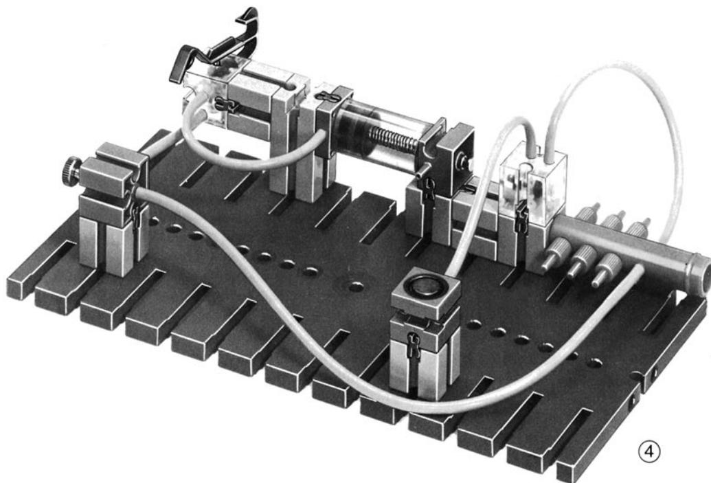
In der Praxis soll häufig der Einschaltvorgang sofort erfolgen, aber die Abschaltung verzögert werden. Hierfür ist die Schaltung einer Treppenhausbeleuchtung ein gutes Beispiel. Wir können dies erreichen, wenn wir für das Ventil II einen Schließer benutzen und den Zylinder 1 einen elektrischen Taster betätigen lassen. Dieser Taster muß, wenn er gedrückt wird, den elektrischem Stromkreis unterbrechen. Die Wirkungsweise der Schaltung ist aus Bild 5-53 zu erkennen:
