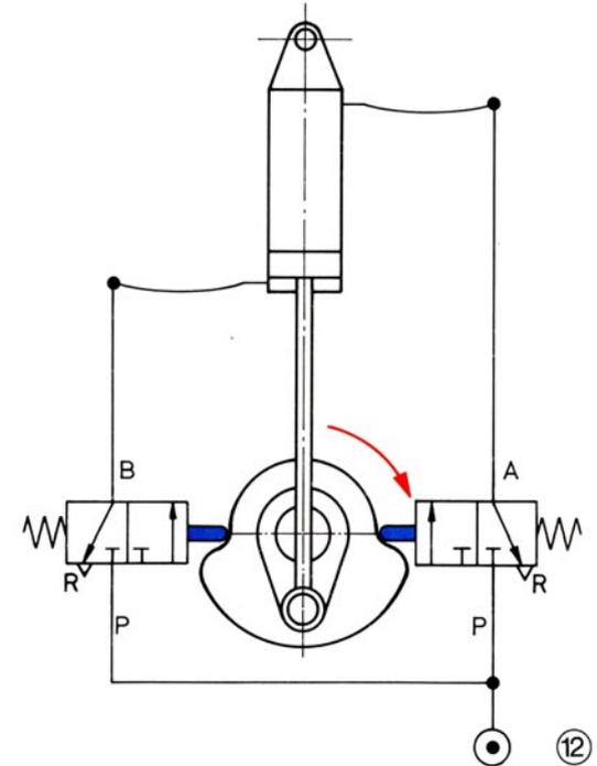
Die Bilder 10–60 bis 13–61 zeigen die Wirkungsweise anhand des Schaltbildes des Motors, Bild 14-61 das zugehörige Modell. Hier haben wir keine Rollenhebel vorgesehen, sondern lassen die Schaltscheiben direkt auf die Stößel der Wegventile arbeiten. Der Verwendung von Rollenhebeln steht natürlich außer dem größeren Raumbedarf nichts im Wege.
