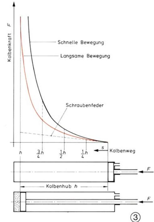
Würde man den Kolben ganz in den Zylinder einschieben, so würde die Luft auf einen unendlich kleinen Raum zusammengepreßt und ihr Druck würde über alle Maßen ansteigen. Aus technischen Gründen läßt sich aber der Kolben nicht so gestalten, daß er die Luft auf das Volumen Null zusammenpressen könnte. Es bleibt immer ein mehr oder minder großes Luftvolumen im Raum vor dem Kolben und im Anschlußstutzen.
