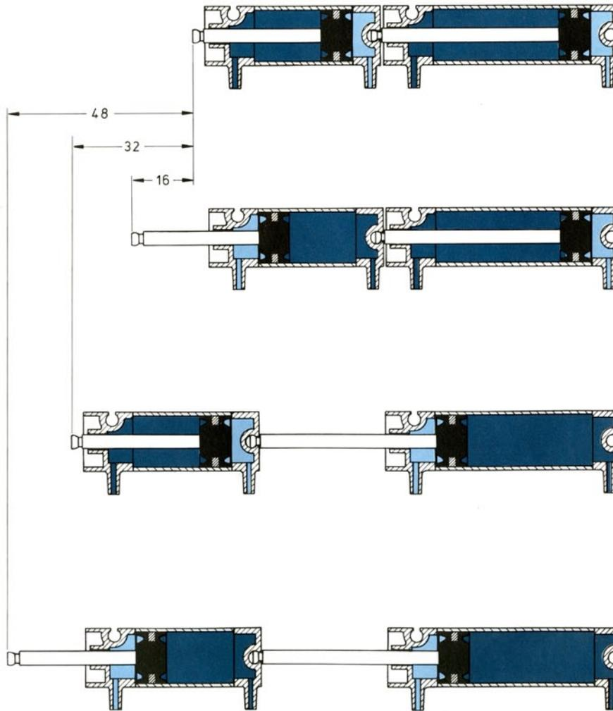
Die beiden Zylinder werden jeder für sich wie ein einfach- bzw. doppeltwirkender Zylinder gesteuert.
