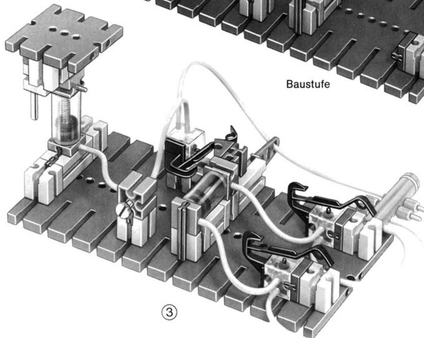
Eine weitere Lösung für ein Impulsventil zeigt Bild 4-41. Hier werden zwei einfachwirkende Zylinder anstelle des doppeltwirkenden eingesetzt. Verwendet man hierzu Betätiger, so nimmt das Ventil besonders wenig Raum ein. Wir kommen im nächsten Abschnitt auf diese Bauweise zurück.
