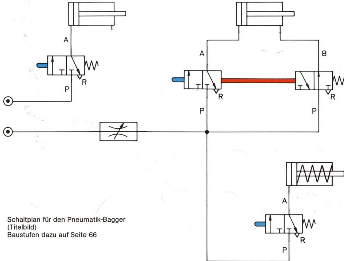
Schaltplan für den Pneumatik-Bagger
