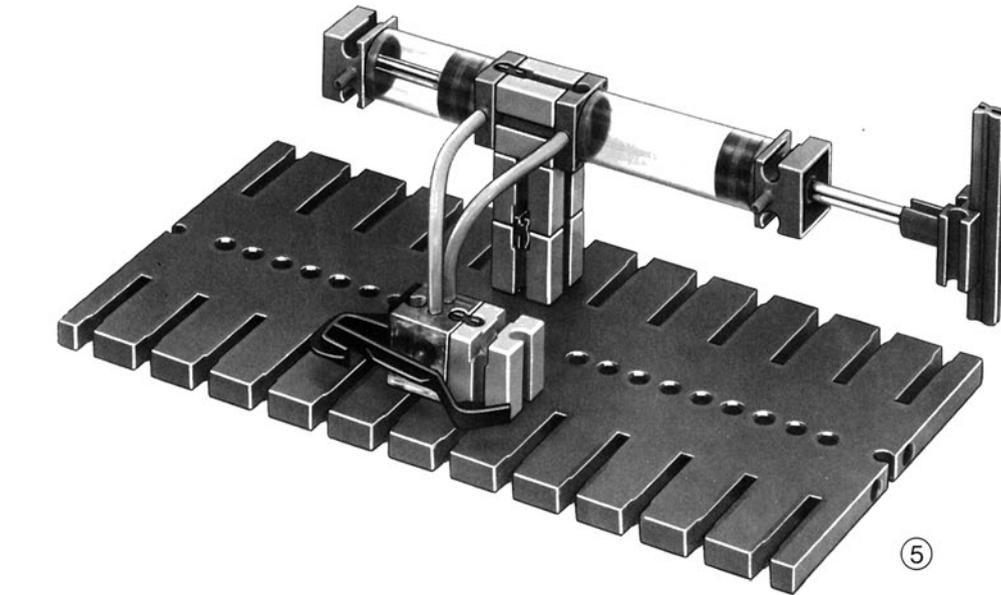
ne Luft in den Verdichterzylinder gelangen kann. Man muß beim Zurückziehen der Kolbenstange das Absperrventil betätigen. Dadurch wird einerseits der Kolben des Arbeitszylinders wie bei einer Saugluftanlage in seine Ausgangslage zurückgesaugt, andererseits wird beim Umschalten des Ventils der Verdichterzylinder kurzzeitig mit der Außenluft verbunden und kann sich so füllen.
