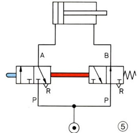
Das Schaltbild 7-33, die Funktionszeichnung Bild 8-33 und der Schaltungsaufbau nach Bild 9-33 zeigen eine weitere Lösungsmöglichkeit unter Verwendung eines Doppelbetätigers. Anwendungen für diese Schaltungen folgen später.
