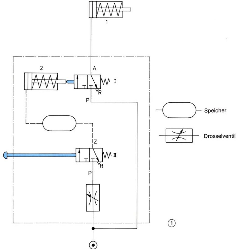
linders verzögert. Der Rückgang setzt sofort ein, weil die Entlüftung des Zylinders 2 über die Steuerleitung Z ungedrosselt erfolgt. Der Zylinder läuft also sofort nach dem Loslassen von Ventil II zurück. Baut man da-
