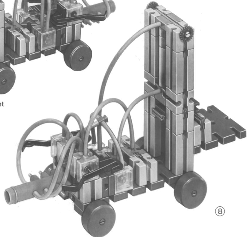
Bild 9-45 zeigt eine Einheit aus Impulsventil und den beiden Steuerventilen. Diese Steuereinheit kann nun für sämtliche Modelle mit doppelwirkenden Zylindern verwendet werden, z. B. für die Drehtür. Benutzt man nur den Öffner des Impulsventils, so können auch einfachwirkende Zylinder gesteuert werden.
