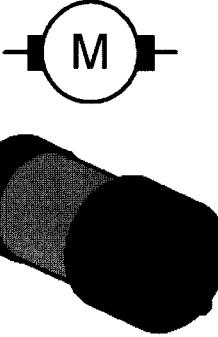
ein Strom durch die Leiterschleife entsteht eine Kraft, die zur Auslenkung des Leiters im Magnetfeld führt; der Rotor bewegt sich. Für praktische Anwendungen ist die einfache Leiterschleife als Spule (mit oder ohne Eisenkern zur Verstärkung des Magnetfeldes) ausgeführt. Sehr viele Gleichstrommotoren erzeugen das notwendige Magnetfeld mit Hilfe von Dauermagneten, die in den Metallmantel des Stators eingeklebt sind. Die Stromzufuhr zum drehenden Rotor erfolgt mit Hilfe von Schleifkontakteen.
