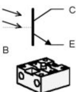
Le phototransistor est un composant électronique semi-conducteur dont les propriétés électriques dépendent de l'intensité lumineuse. Un transistor ordinaire est un composant à trois raccordements. Ces raccordements sont appelés Émetteur, Base et Collecteur. Sa fonction principale est d'amplifier les
