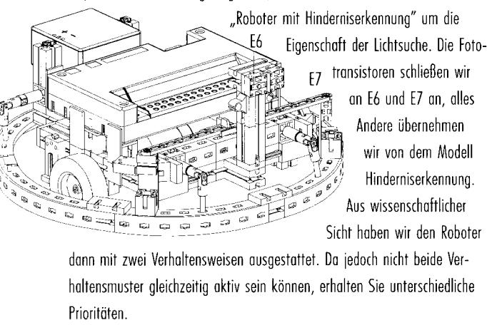
Für uns stellt sich dies so dar, dass der Roboter im Normalfall auf Lichtsuche ist. Wird ein Hindernis erkannt, quasi eine Gefahr für den Roboter, wird das Verhalten Hindernisvermeidung aktiv. Ist alles wieder im grünen Bereich, kann der Roboter weiter nach der Lichtquelle forschen.
