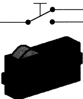
Die einfachen logischen Pegel „0“ und „1“ sind mit Hilfe eines Schalters darstellbar.
