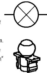
Eine Einsatzmöglichkeit der Glühlampe ist das Anzeigen von Schaltzuständen. Durch das Programmieren einer blinkenden Lampe können auch Warnmeldungen erzeugt werden.
