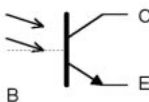
No caso de um fototransistor trata-se de um elemento semicondutor, cujas propriedades elétricas dependem do grau de luminosidade. Um transistor simples é um elemento com três conexões. Estas conexões são identificadas como emissor, base e coletor. Sua tarefa principal é a ampliação de sinais fracos. Uma corrente fraca, que flui
