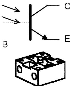
Beim Fototransistor handelt es sich um ein Halbleiterbauelement, dessen elektrische Eigenschaften lichtstärkeabhängig sind. Ein gewöhnlicher Transistor ist ein Bauelement mit drei Anschlüssen. Diese Anschlüsse werden als Emitter, Basis und Kollektor bezeichnet. Seine Hauptaufgabe ist die Verstärkung schwacher Signale. Ein schwacher Strom, der
