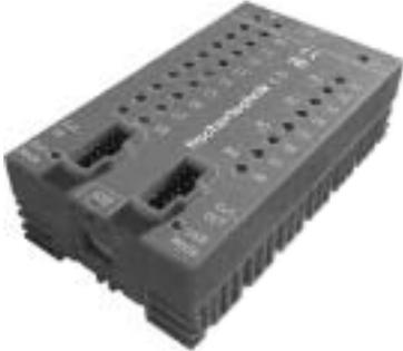
■ Voordat je begint met het bouwen van de modellen en programma's gaat schrijven, moet je de besturingssoftware ROBO Pro op je pc installeren en de interface "ROBO I/O-Extension" via de USB-interface op je computer aansluiten.
