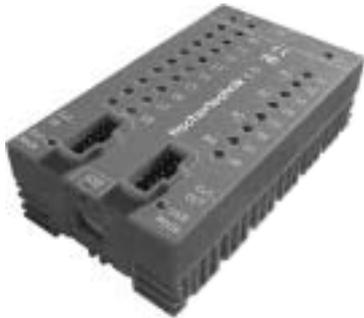
■ Avant de commencer à construire des modèles et d'élaborer des programmes, vous devez installer le logiciel de commande ROBO Pro sur votre PC et raccorder ensuite l'interface « ROBO I/O-Extension » par l'interface USB à votre PC.
