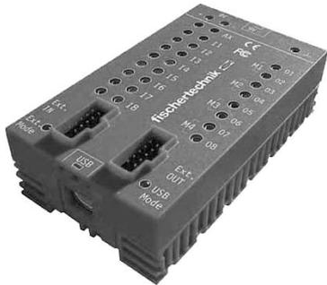
■ Bevor du anfängst Modelle zu bauen und Programme zu erstellen, musst du die Steuerungssoftware ROBO Pro auf deinem PC installieren und danach das Interface „ROBO I/O-Extension“ über die USB-Schnittstelle an deinen Rechner anschließen.
